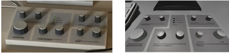
图6 真实扫描电镜操作盘和对应仿真模型
