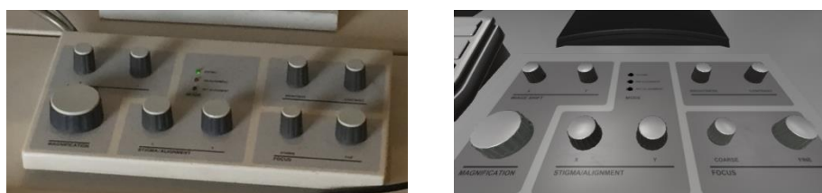
图 2 真实扫描电镜操作盘和对应仿真模型
